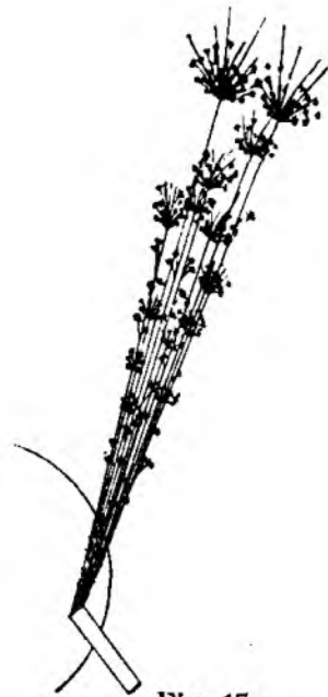
Fig. 17. Acciaio al manganese.
